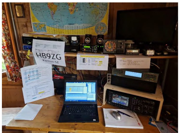
Abbildung 2 : Funkplatz mit TS-890, 2KFA, Logger PC und einer ganzen Sammlung von kurz Anleitungen, z.B. für die Stepp IR
